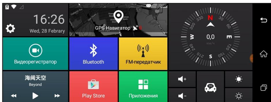
После включения устройства оно автоматически войдет на главный экран, с которого можно перейти на другой рабочий экран (необходимо провести пальцем вправо или влево), а также отображается информация о системном времени, состоянии видеорегиcтpатора, средств связи Bluetooth, WiFi и FM-передатчика (в зависимости от того, используются ли эти функции системой).
