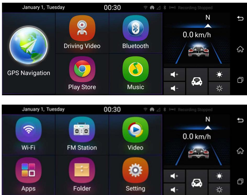
После включения устройства оно автоматически войдет на главный экран, с которого можно перейти на другой рабочий экран (необходимо провести пальцем вправо или влево), а также отображается информация о системном времени, состоянии видеоре- гистратора, средств связи Bluetooth, WiFi и FM-передатчика (в зависимости от того, используются ли эти функции системой).
